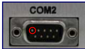
Enclosure TS-540 COM2 Port, Pin 1
